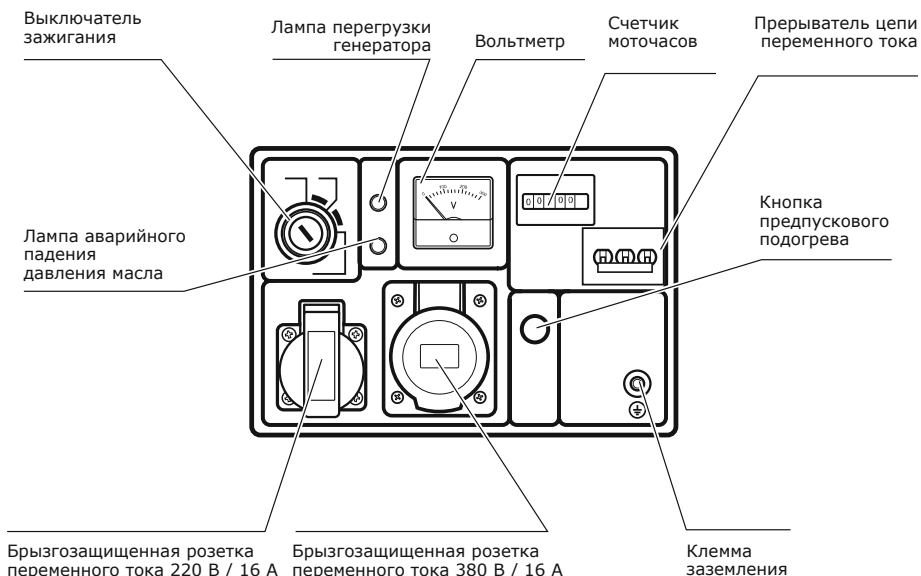
Рис. 3. Схема панели управления генератора УГД-6000ЕТ/4 кВт, УГД-7500ЕТ.
