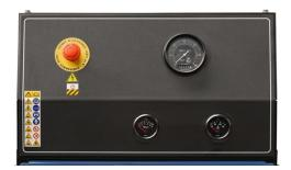
Пульт M80 имеет двойное назначение. Он служит обычной контактной платой для соединения электрошкафа и щитка приборов, чьи инструменты позволяют отслеживать путем прямого считывания основных параметров вашего электроагрегата.
