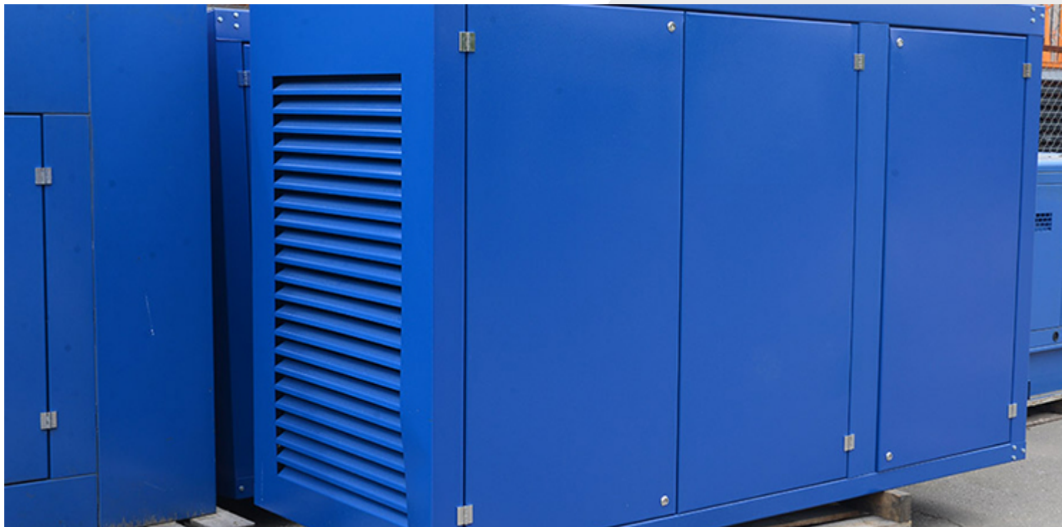
Кожух изготавливается из листовой стали толщиной не менее 1,5 мм, имеет проемы приточной и вытяжной вентиляции, защищенные стальными жалюзийными решетками
